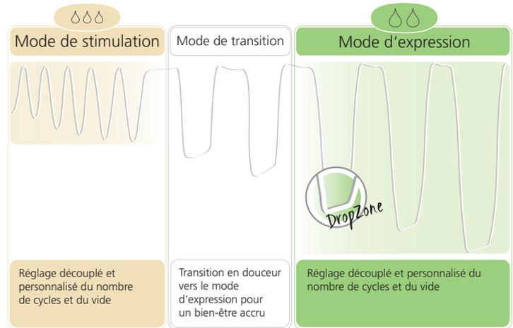
Dans la **"DropZone"**, un vide stable est maintenu au niveau réglé. Il permet de garantir un écoulement continu et sans encombres du lait maternel. Notamment dans le cas d'un cycle inférieur, la **"DropZone"** contribue à exprimer efficacement étant donné que le lait a davantage de temps pour s'écouler.
