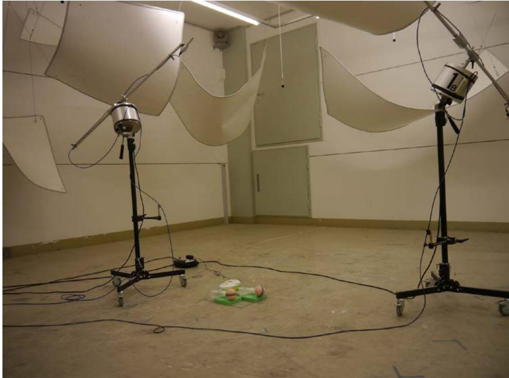
Abbildung B.3. Prüfanordnung im Hallraumboden.
