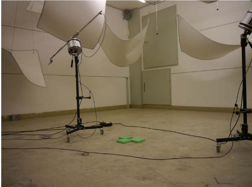
Abbildung B.1. Hallraum und Prüfposition ohne Prüfobjekt.
